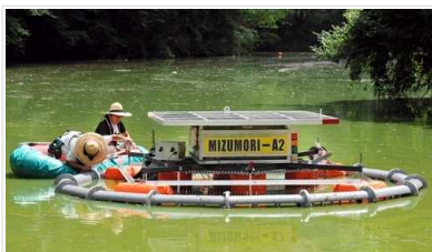
開発した装置を浮かべて行われたアオコ除去の実証実験＝八代市泉町下岳の氷川ダム湖
